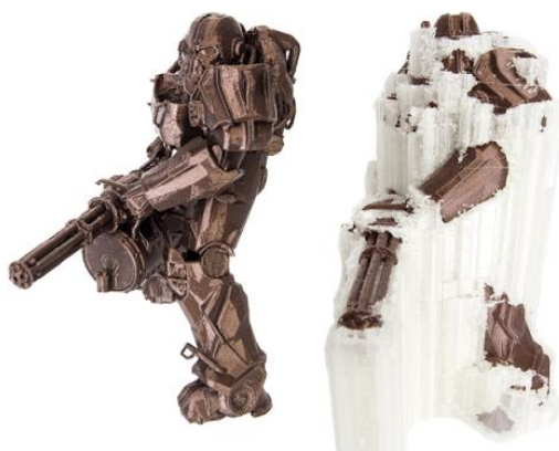
Obrázek 4 - Model s využitím podpurného materiálu (11)
