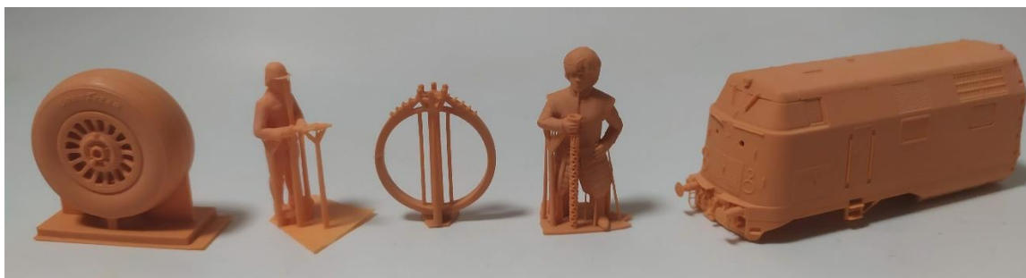
Obrázek 20 - RC Modely pomocí SLA
