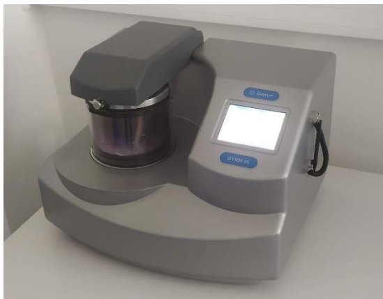
Obrázek 50 - Pokovovací přístroj Quorum Q150Res
