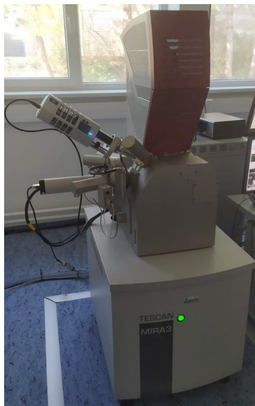
Obrázek 51 - SEM TESCAN MIRA3 GTX
