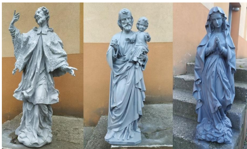
Obrázek 21 - Vytisknuté sochy pomocí FDM
