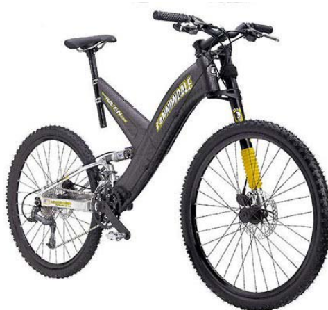
Obr. 9 Celoodpružený karbonový rám Cannondale Raven s vidlicí Lefty ( http://www.pinkbike.com )
