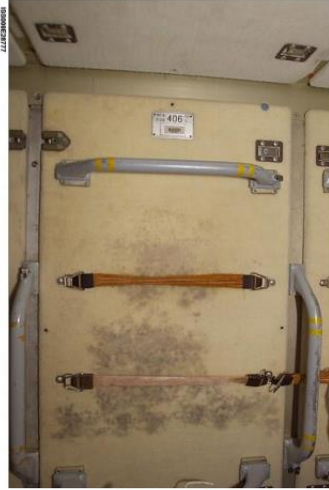
Panely s „plísní“ v hygienické oblasti ISS. Rostla zde v důsledku kontaktu s mokřými ručníky. Dotčená plocha je zhruba 2 m 2 .
