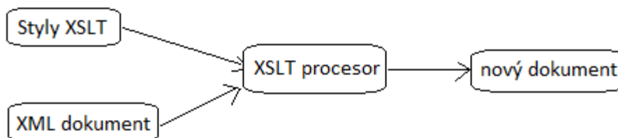
Obrázek 2.2: Ukázka principu transformace (inspirováno podle[1]).
