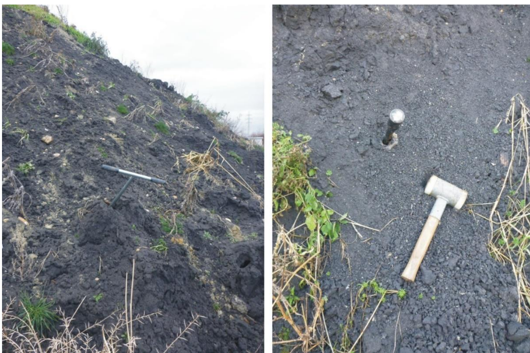
Obrázek 24: Ukázka provedené sondáže, vlevo deponie/vrták, vpravo/sondyrka (foto autorka ve spolupráci s VÚMOP, v.v.i.).
