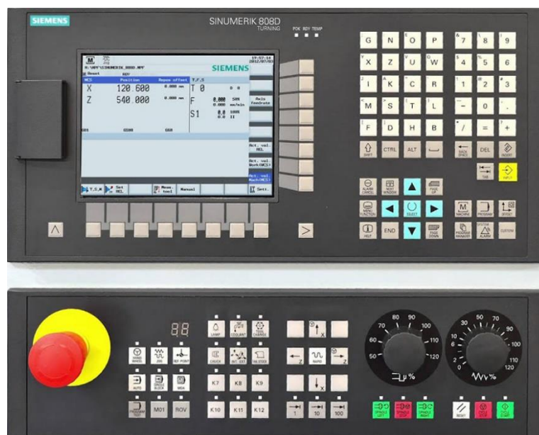
Obrázek 3.4 Řídicí panel řídicího systému SINUMERIK [20]
