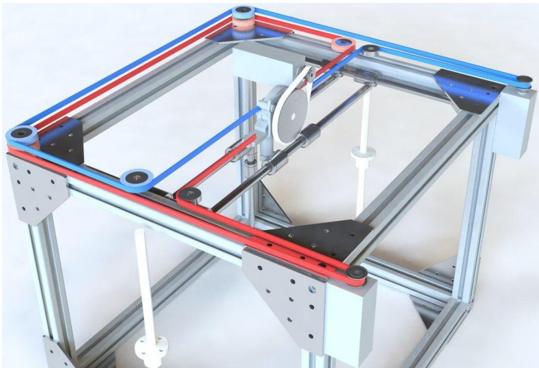
Obrázek 6.4 Rozvodové řemeny CoreXY 3D tiskárny [38]
