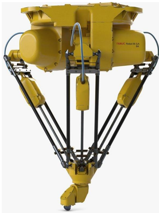
Obrázek 2.2 Manipulátor Fanuc M-3 s paralelní kinematikou [10]
