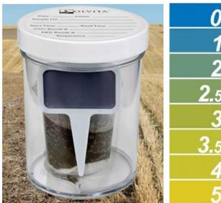
Obrázek 8: Respirační gelová sonda s barevnou tabulkou k interpretaci množství CO 2 [80]
