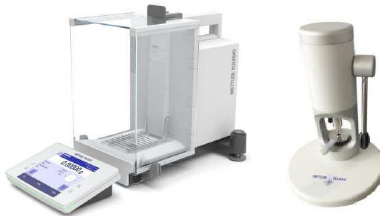
Obr. 3.31 Analytické váhy Mettler Toledo XSE 105 Dual Range (vlevo) [62] a ruční lis Mettler Toledo (vpravo)
