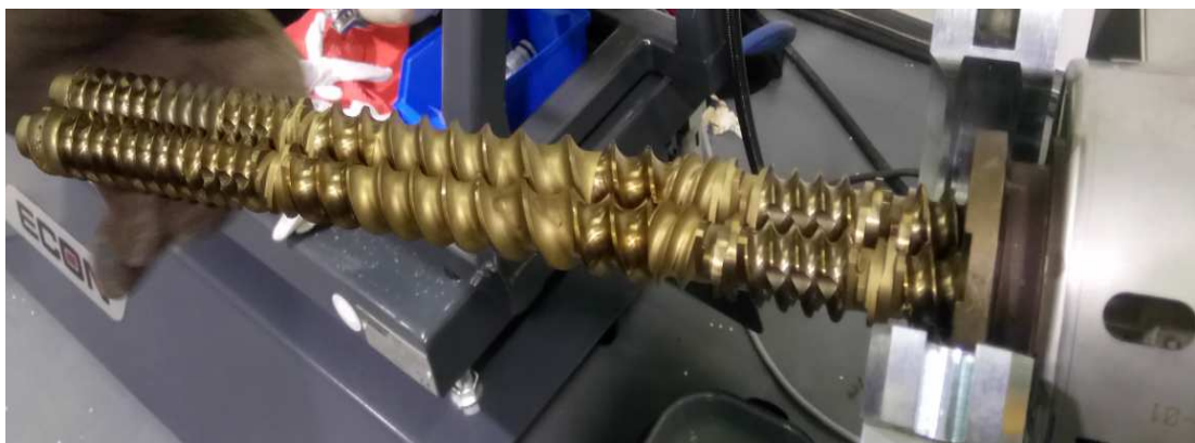
Obr. 3.9 Detail segmentových šneků extrudéru Collin Lab-Line ZK 25E
