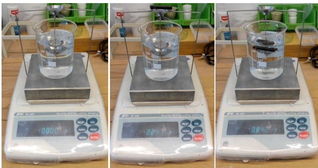
Obr. 3.22 Analytické hustotní váhy AND GF-300 a postup měření hustoty materiálu
