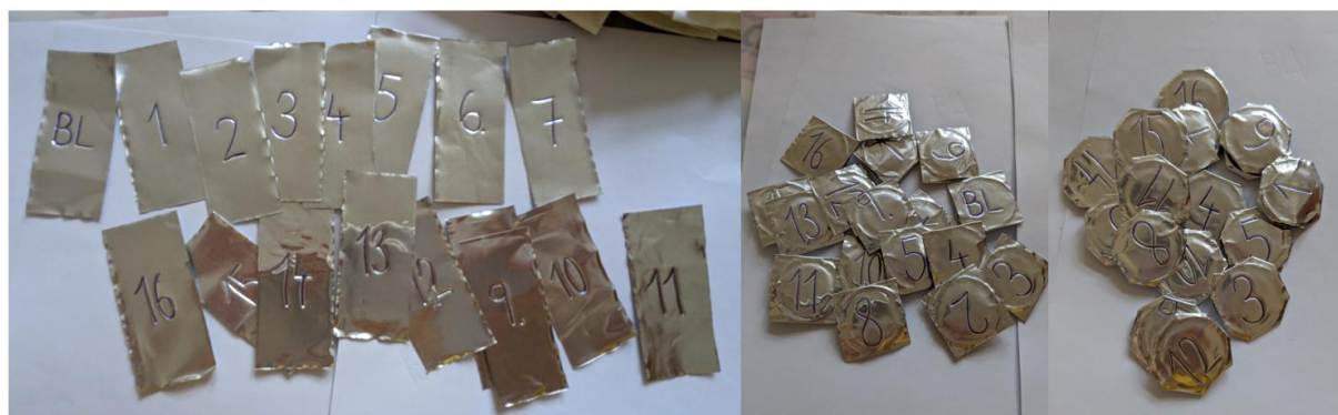
Příloha 11 Připravené popsané hliníkových proužky bez vzorků; vzorky zabalené v proučích; vzorky se zastříženými rohy hliníkových proučků (aby se daly naskládat do tuby) (vlastní tvorba)
