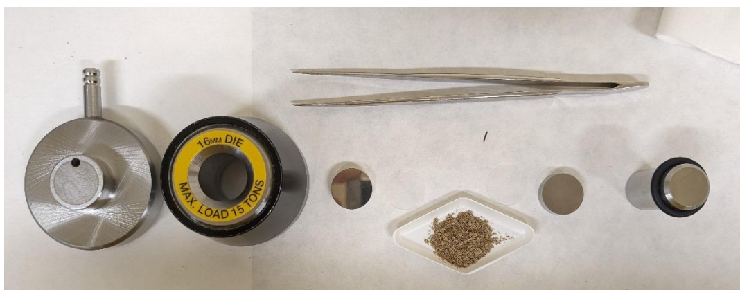
Obrázek 16 Tabletovačka a její součásti zleva – spodní část, středová část, spodní kovový válec, průhledná folie, vzorek, průhledná folie, vrchní kovový válec, těsnicí válec (vlastní tvorba)
