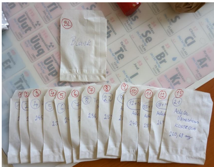
Příloha 10 Poslední fáze přípravy vzorků pro INAA. Zleva popsané vzorky hmyzu a slepý pokus (vlastní tvorba)
