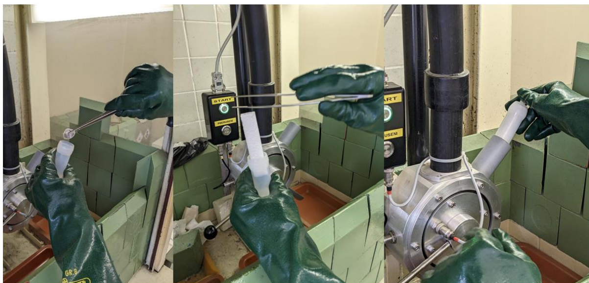
Obrázek 17 Zleva vkládání a utěšňování obaleného vzorku do transportního pouzdra (králíka) a umísťování do zařízení potrubní pošty (vlastní tvorba)
