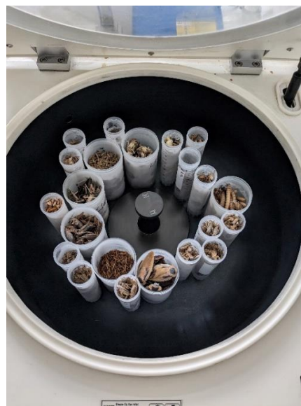
Obrázek 13 Lyofilizátor se vzorky před spuštěním (vlastní tvorba)
