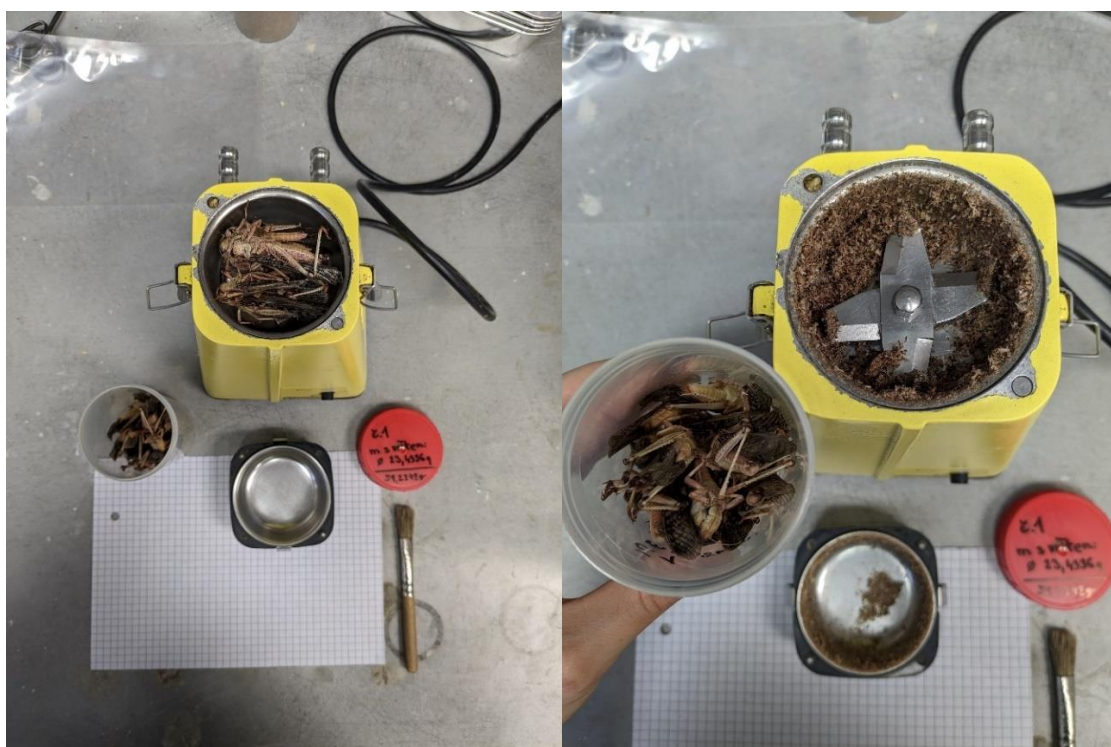
Příloha 7 Homogenizace lyofilizovaných vzorků hmyzu v mlýnku IKA Yellowline A10 (vlevo před homogenizací, vpravo po homogenizaci) (vlastní tvorba)
