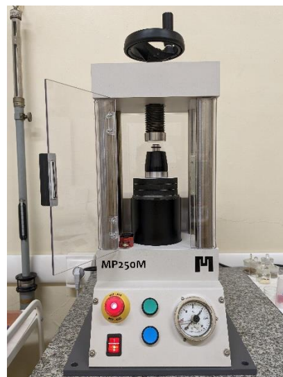
Obrázek 15 Laboratorní lis MP250M s vloženým tabletovacím zařízením (vlastní tvorba)
