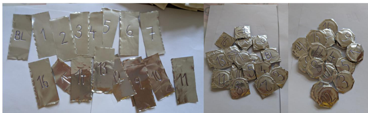
Příloha 11 Připravené popsané hliníkových proužky bez vzorků; vzorky zabalené v proužcích; vzorky se zastříženými rohy hliníkových proužků (aby se daly naskládat do tuby) (vlastní tvorba)
