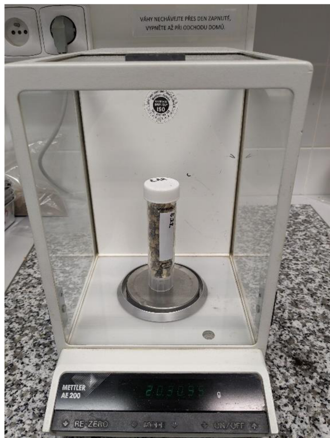
Příloha 6 Vážení lyofilizovaných vzorků na analytických vahách Mettler Toledo AE 200 (vlastní tvorba)
