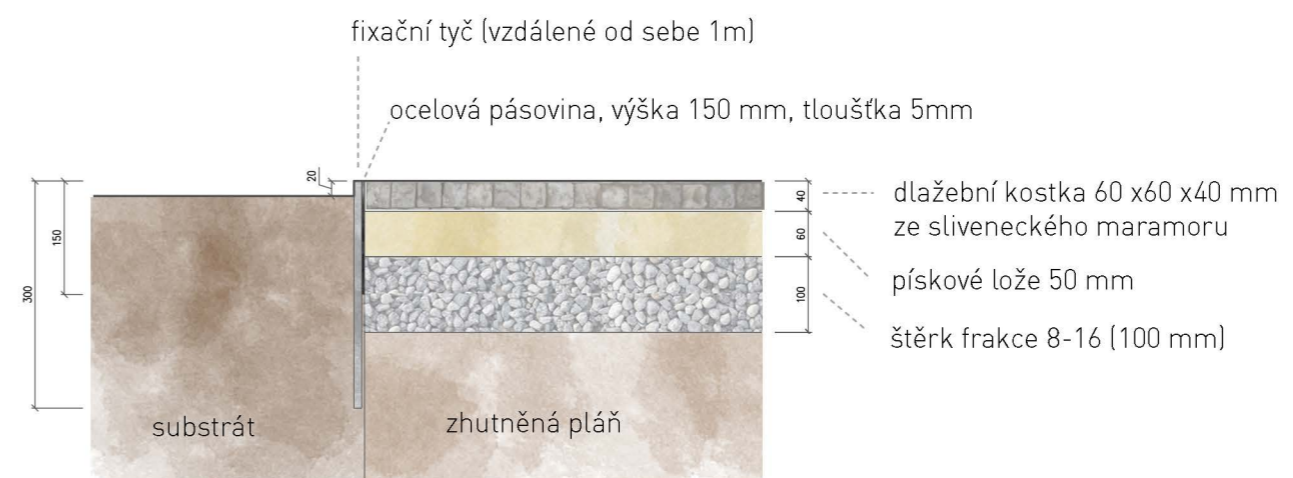
Obr. 116 Detail přechodu mezi dlažbou a záhonem (1:10)
