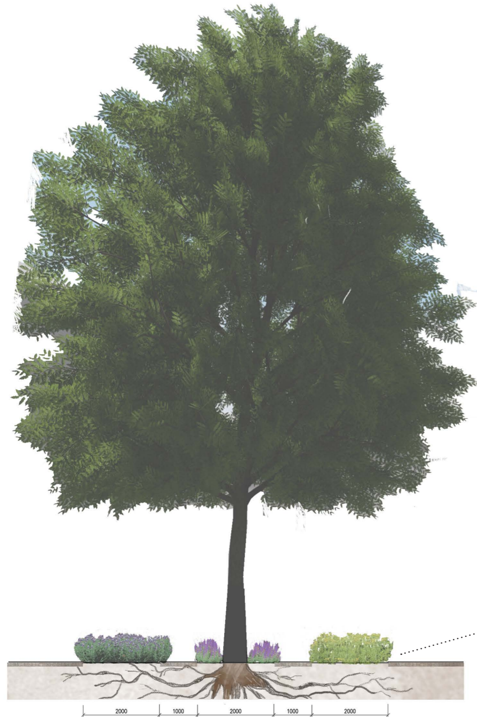
Obr. 115 Řez AA' vytvořeným prokořenitelným prostorem pro strom (1:100)
