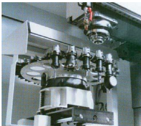
Obr. 2.3 Hvězdicový zásobník s výměnou nástroje Pick-Up [2]
