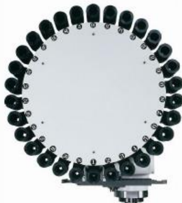
Obr. 2.3 Bubnový zásobník s ramenovým výměníkem [20]
