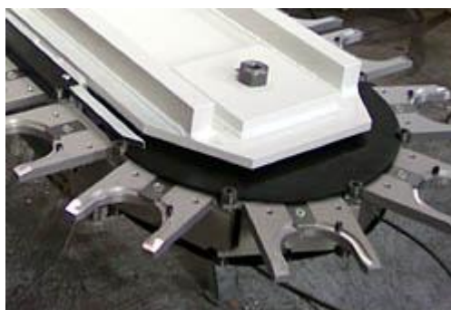
Obr. 2.12 Držák nástrojů v zásobníku od firmy KBH CZ [14]
