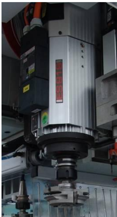
Obr. 4.6 Vertikální vřeteno stroje FASTER od firmy Sahos [9]
