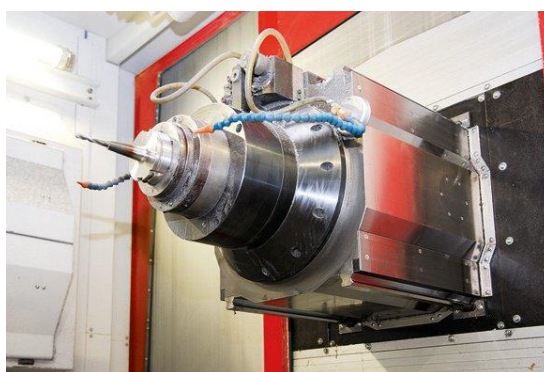
Obr. 4.7 Horizontální vřeteno stroje Trimill HC 1212 [25]
