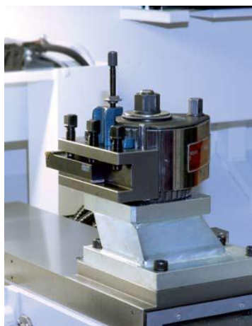
Obr. 3.1 Rychloupínač Mulifix od firmy Kovosvit MAS [16]
