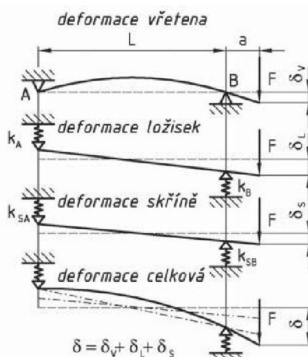
Obr. 4.3 Deformace vřetena – vliv tuhosti, ložisek, skříně [1]
