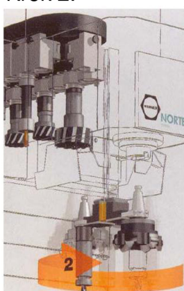
Obr. 2.10 Automatická výměna nástrojů pomocí ramenového výměníku [13]
