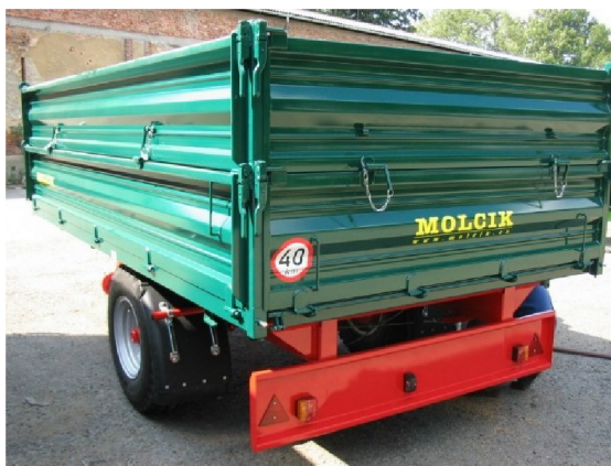
Obr. 7 Třístranně sklápěný návěs FARMTECH– EDK 650 [7]
