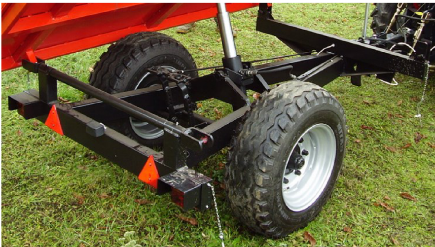
Obr. 8 Trojúhelníkový (vidlicový) rám [16]
