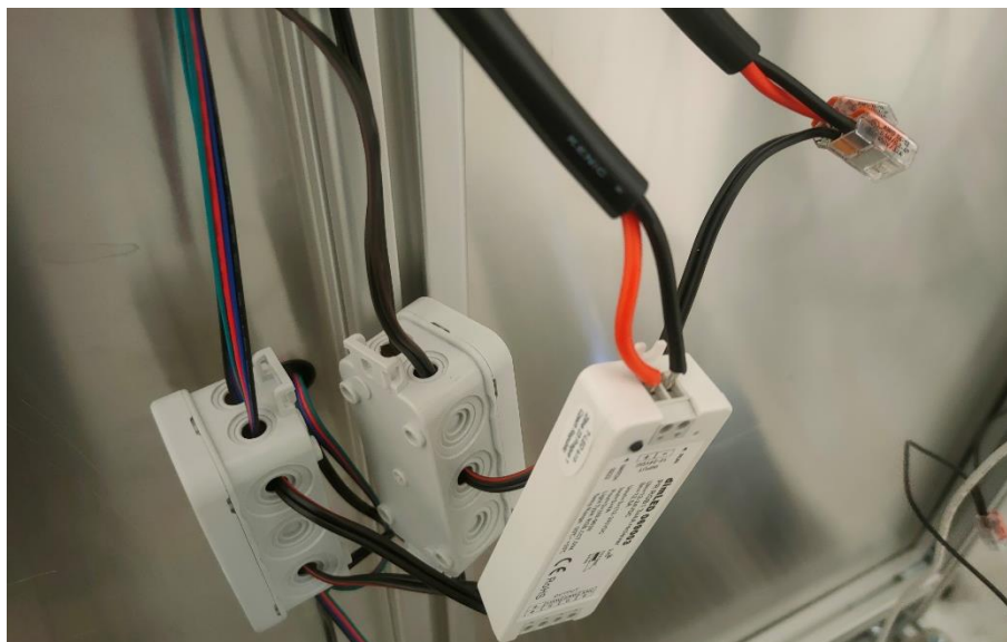
Obr. 25 Zapojení řídicí jednotky mezi zdroj a rozvody
