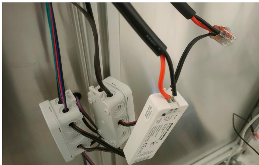
Obr. 25 Zapojení řídicí jednotky mezi zdroj a rozvody
