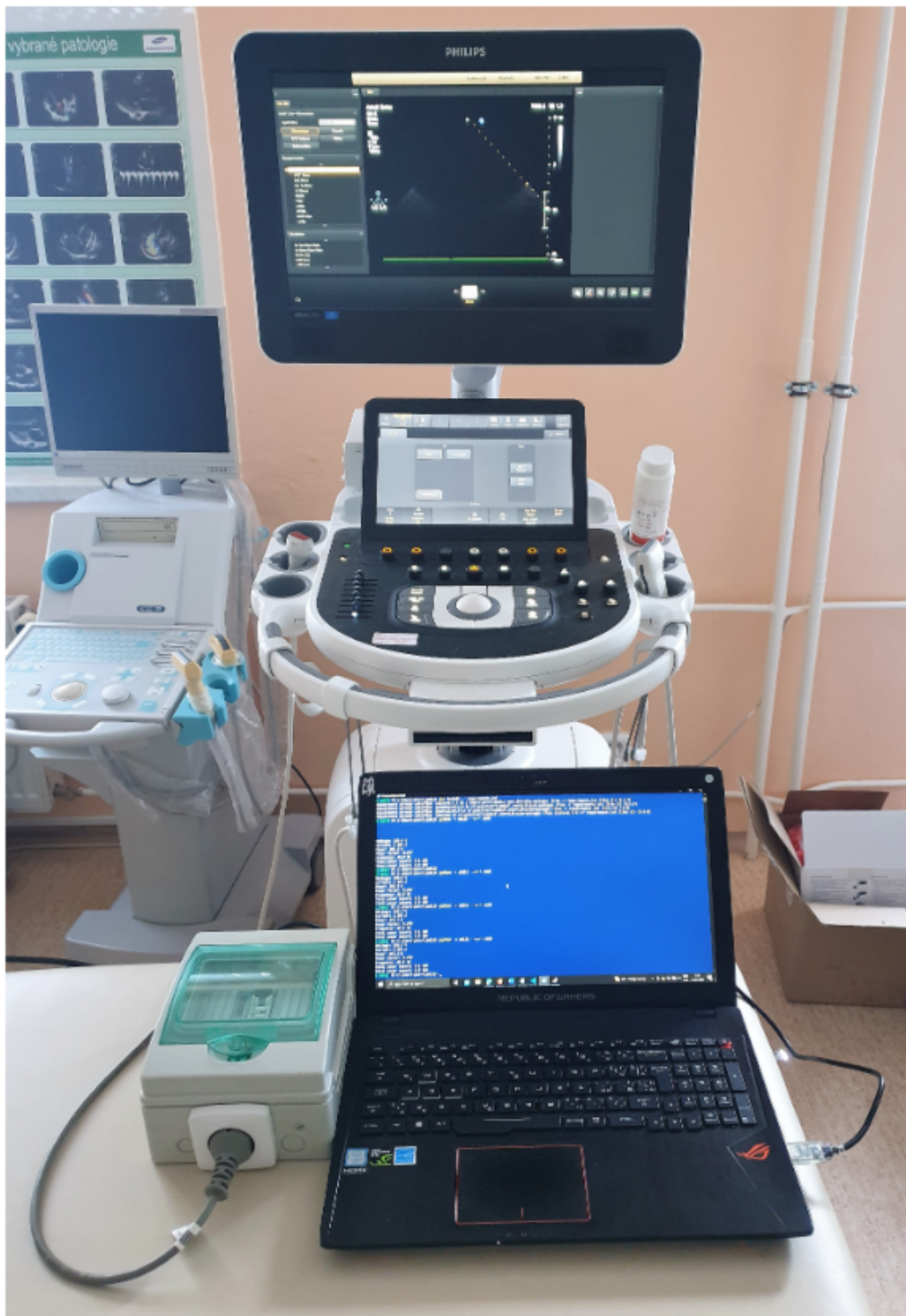
Obrázek A.30: Testování prototypu inteligentní zásuvky na ultrazvuku Philips Affiniti 50G
