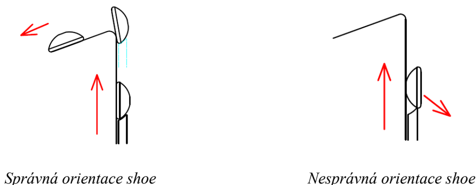
Obr. 28 Princip zdvihání shoe
