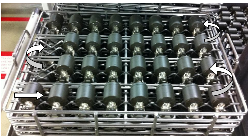
Obr. 35 Systém odebírání pístů z koše
