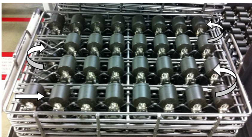
Obr. 35 Systém odebírání pístů z koše
