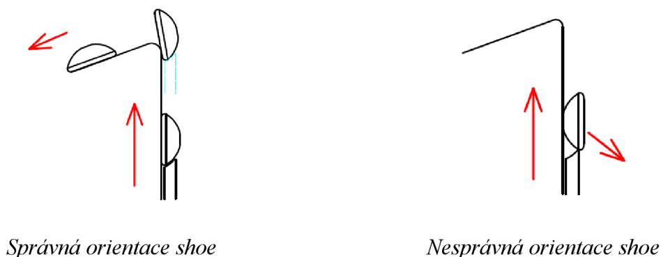
Obr. 28 Princip zdvihání shoe
