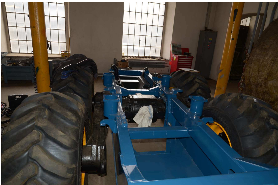
Obr. 141 Podvozek na rámu budoucího prototypu vyvážecí soupravy LVS710. 2. 4. 2013, montážní hala firmy Strojírna Novotný, Vitošov
