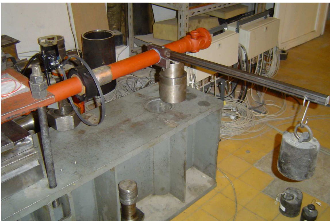
Obr. 137 Kalibrace snímače točivého momentu kardanu
