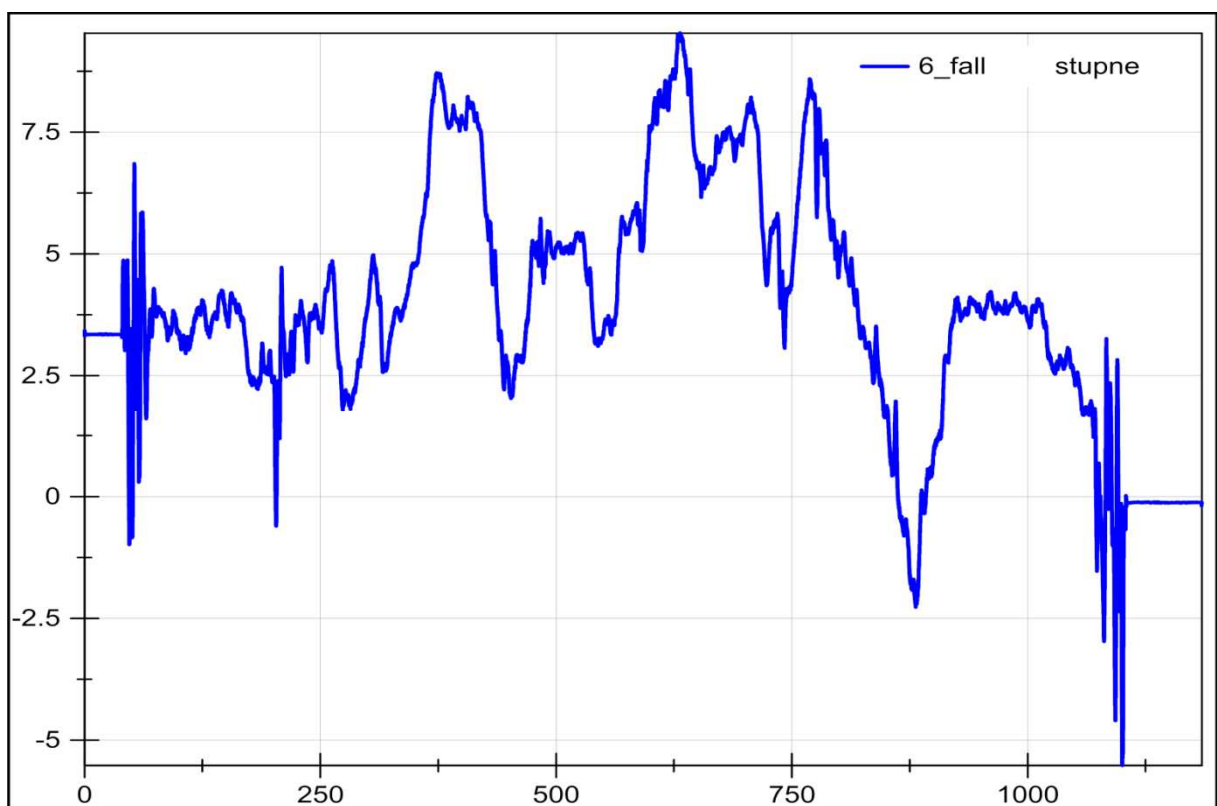
Obr. 149 Sklon asfaltové cesty z haly na pilu v Olomučanech – čidlo č. 67
