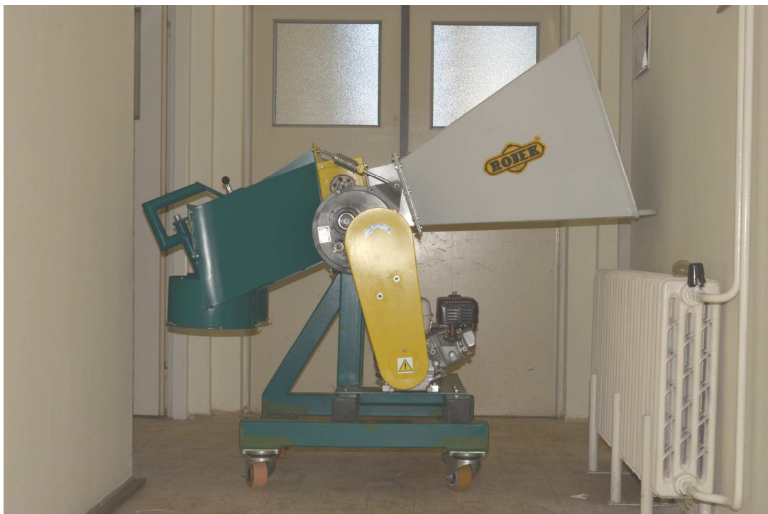
Obr. 23 drtič Rojek DH10sp s úpravou podvozku [KLEPÁRNÍK & VEVERKA, 2011]
