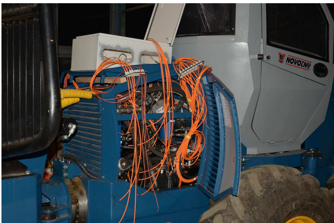
Obr. 142 LVS710 montáž měřicího systému – realizace kabeláže 22. 9. 2013, montážní hala Mendelovy univerzity, Josefov
