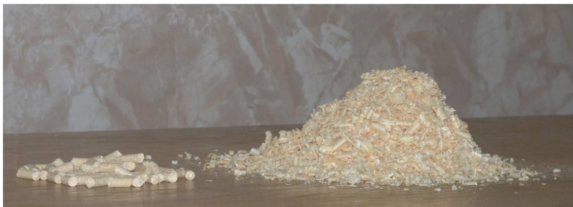
Obr. 26. Vliv komprese paliva na energetický obsah. Hromádky obou obchodních forem biomasy představují stejný energetický obsah.
