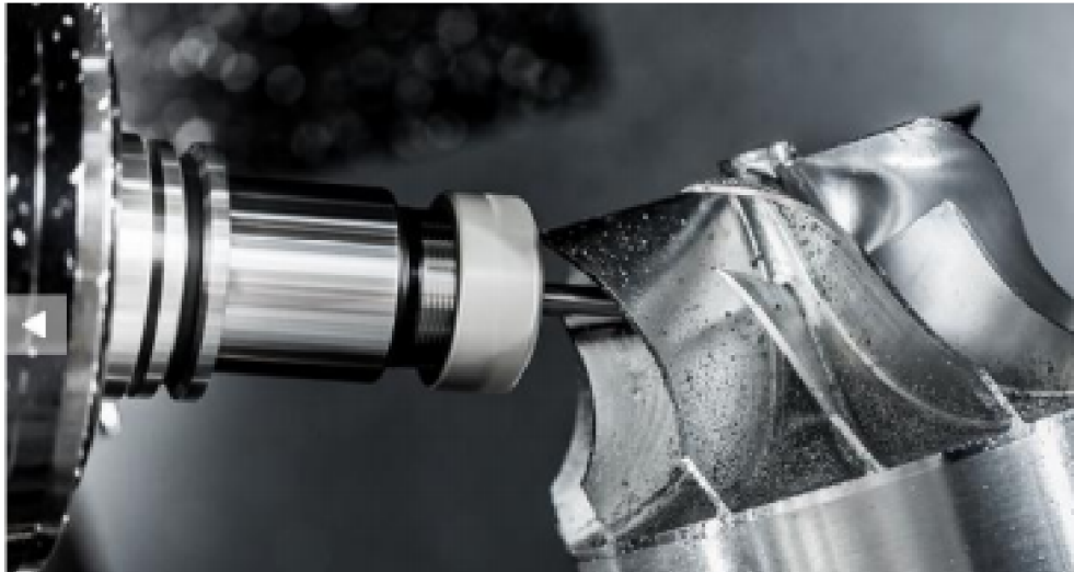
Obr. 3.4 Frézovací těleso pro obrábění zdokonalené firmou TGS Zdroj: Archiv společnosti TGS.
