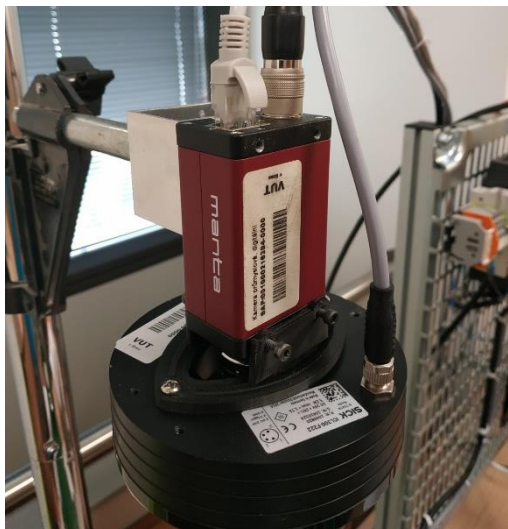
Obr. 41) Uchycení prstencového světla k tělu kamery
