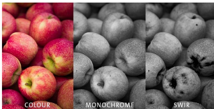
Obr. 16) Jablka pod běžným a infračerveným osvětlením [22]
