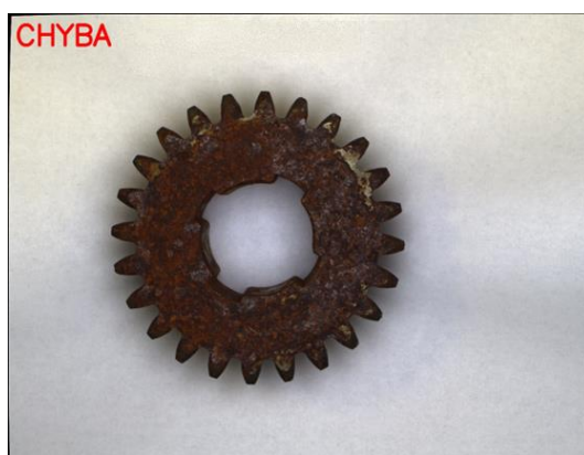
Obr. 54) Zkorodované ozubené kolo
