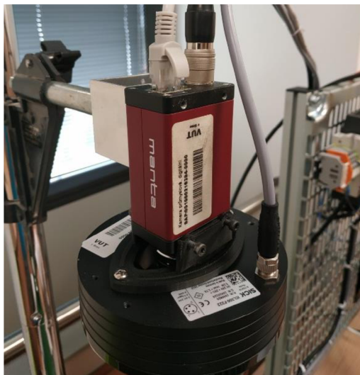
Obr. 41) Uchycení prstencového světla k tělu kamery
