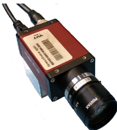
Obr. 39) Průmyslová kamera Manta G033B od výrobce Allied Vision s objektivem Pentax C1614-M
