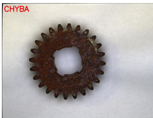
Obr. 54) Zkorodované ozubené kolo
