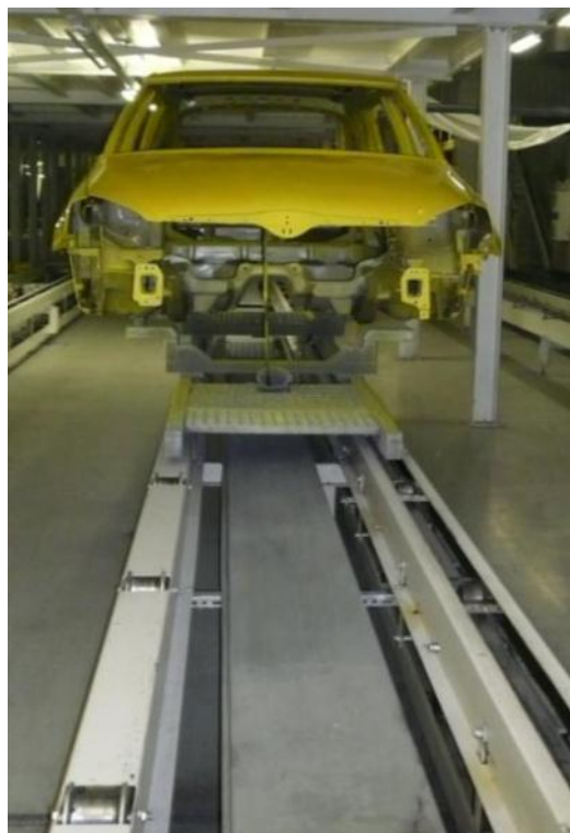
Obr. 16.: Přesouvání karos. na pásovém dopravníku směrem k montáži [15]
