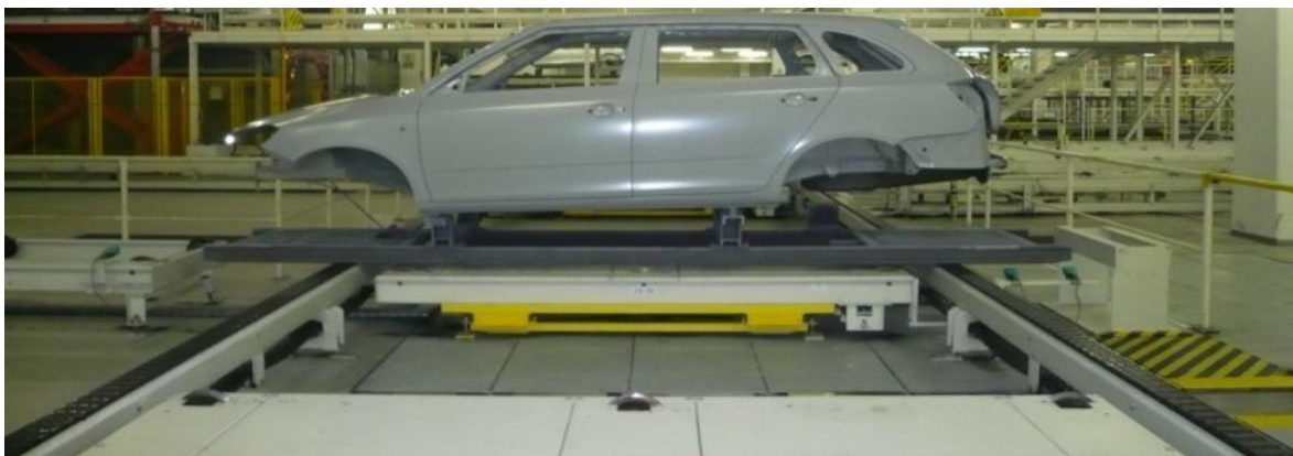
Obr. 17.: Přejezd karoserie po nástřiku plniče prostřednictvím pásového dopravníku [15]
