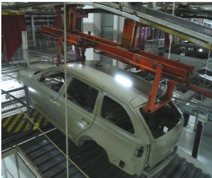
Obr. 13.: Závěs nesoucí karoserii na stoupání [15]
