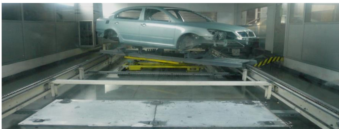
Obr. 21.: Otočení a přejezd karoserie mezi stříkacím boxem a mezipecí [15]
