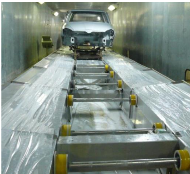
Obr. 15.: Válečková trať v okapové zóně po nanášení kataforézy [15]
