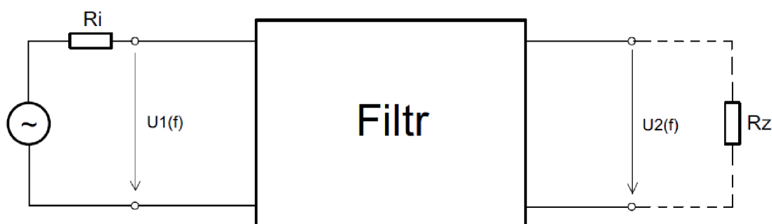
Obr. 1.1: Filtr jako dvojbran (upraveno podle [8]).
