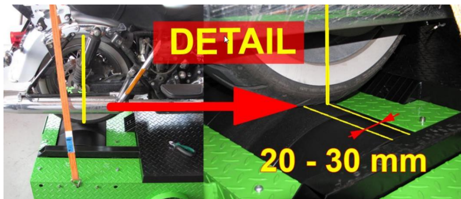
Obr. 23: Poloha zadního kola na válci
