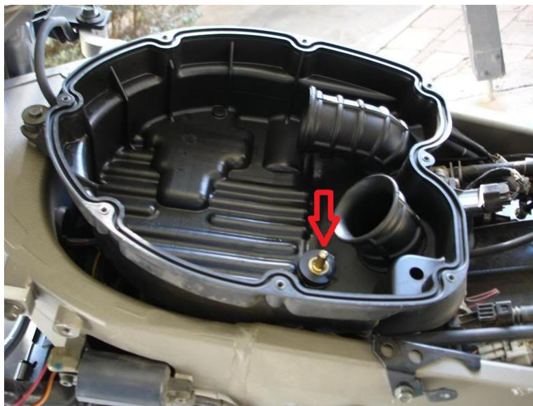
obr. 18: Umístění čidla teploty v sání
