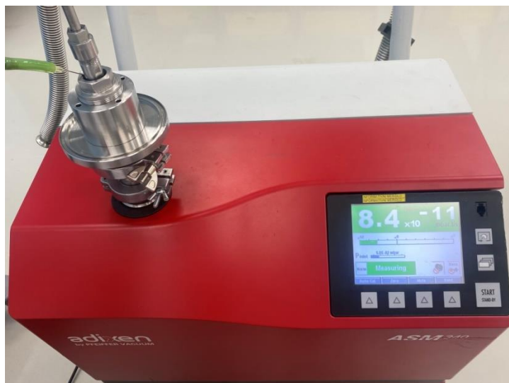
Obrázek 48: Průběh měření těsnosti průchodky s mikromanipulátorem.
