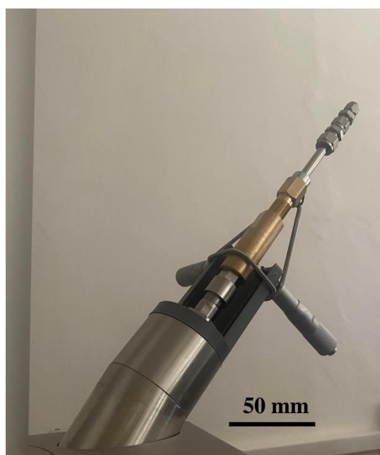
Obrázek 43: Kompletní prototyp průchodky s mikromanipulátorem v SEM.
