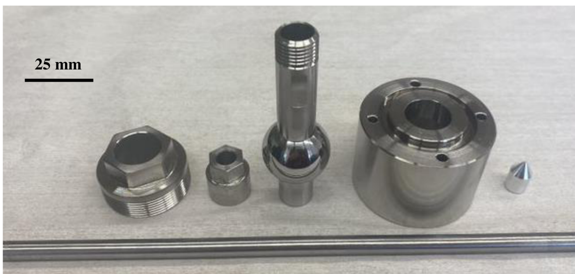
Obrázek 42: Zhotovené součástky průchodky s mikromanipulátorem
