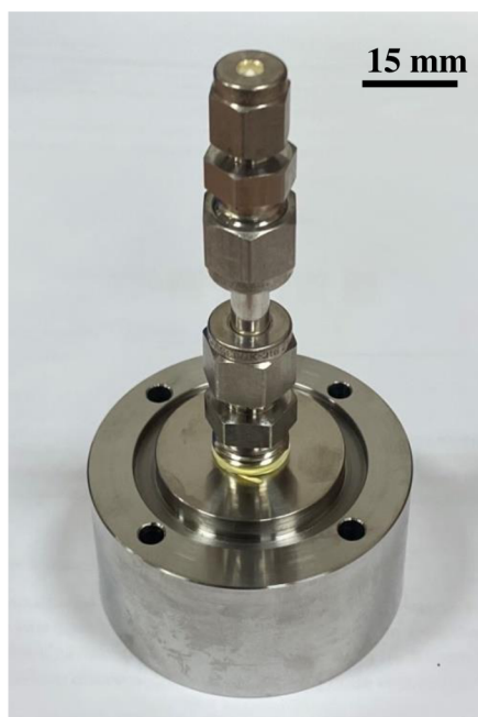
Obrázek 21: Hotová sestava průchodky bez manipulátoru.
