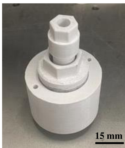
Obrázek 34: Vytištěný prototyp průchodky s mikromanipulátorem.
