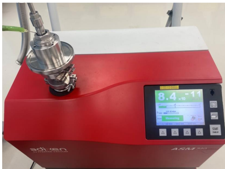
Obrázek 48: Průběh měření těsnosti průchodky s mikromanipulátorem.
