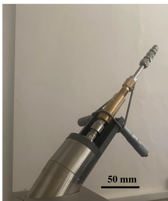
Obrázek 43: Kompletní prototyp průchodky s mikromanipulátorem v SEM.
