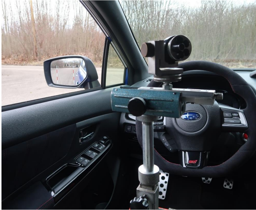
Obrázek 36: Optické průhledové zařízení ve vozidle
