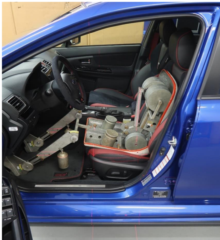
Obrázek 30: Figurína 3DH ve vozidle
