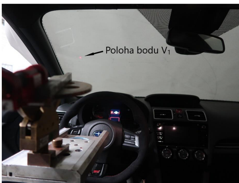
Obrázek 31: Pozice bodu V1 ve vozidle
