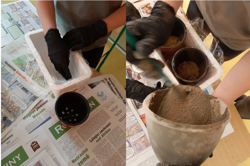
Obrázek 20 vystlání formy separační fólií, lití namíchané směsi mezi formy (archiv autora)
