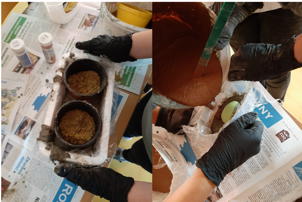
Obrázek 20 vystlání formy separační fólií, lití namíchané směsi mezi formy (archiv autora)
