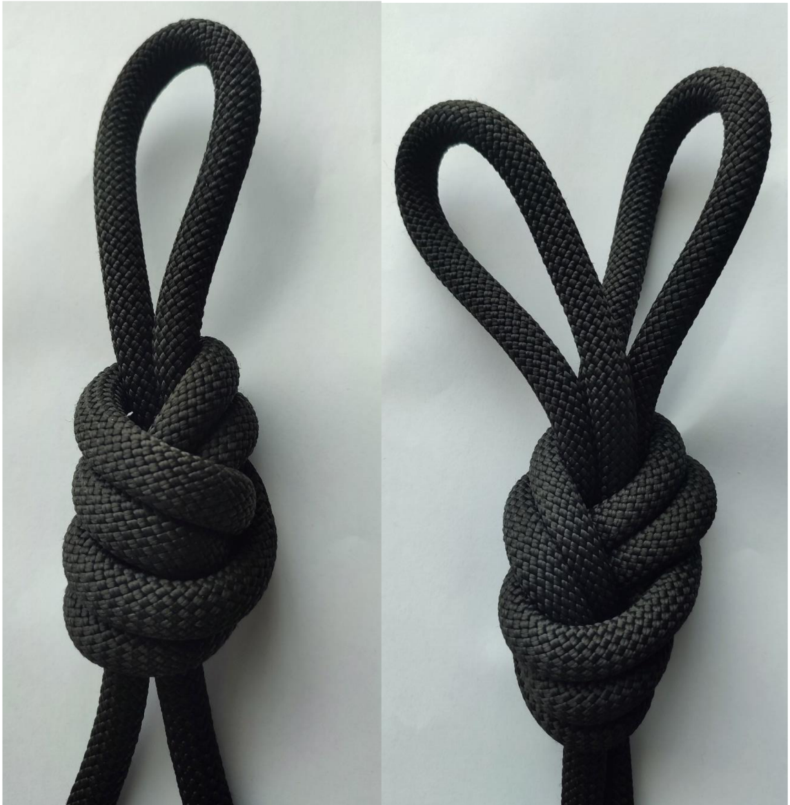
Obrázek 5 - Devítkový a dvojitý osmičkový uzel. 18
