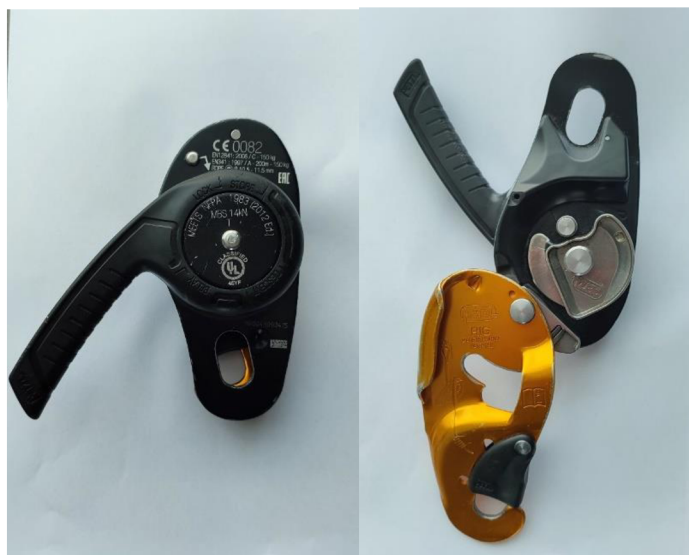
Obrázek 3 - Slaňovací brzda RIG Petzl. 13
