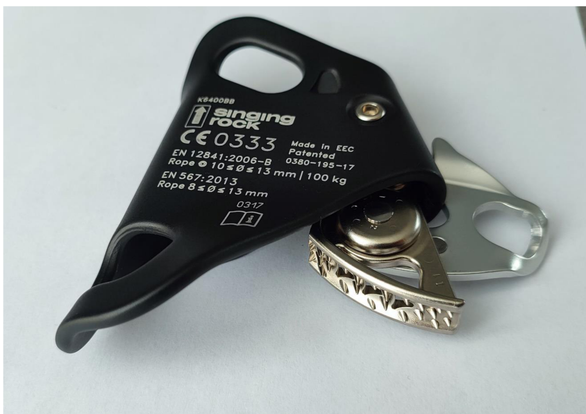
Obrázek 4 - Hrudní blokant - detail mechanismu blokujícího posun po laně. 14
