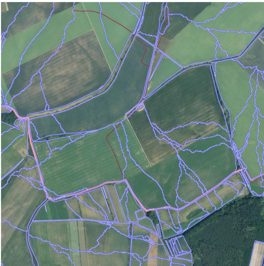
Obrázek 16, Příklad snímku obrazovky s EUC – zobrazení vrstvy EUC na webovém portálu Monitoring eroze ( https://me.vumop.cz ), příklad na PB 8501/3. Pomocí takového snímku bylo možné provést vektorizaci hranic EUC v ArcGIS Pro.
