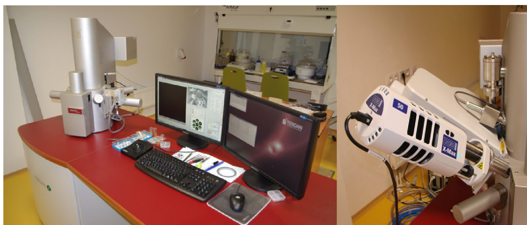
Obr. 4.10 SEM MIRA II/LMU firmy TESCOAN s.r.o. s vestavěným EDX detektorem.
