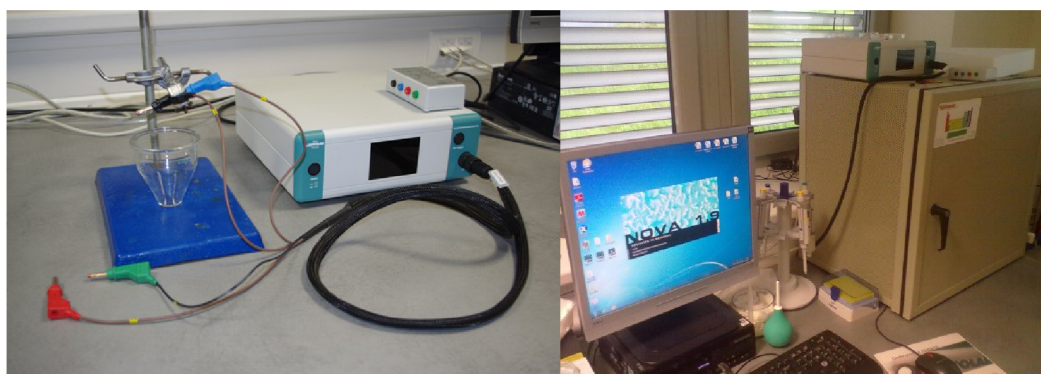
Obr. 4.8 Sestava se skleněnou měřící nádobou (vlevo) pro elektrochemická měření \mu Autolab III s FRA2 modulem a Faradayovou klecí (vpravo).
