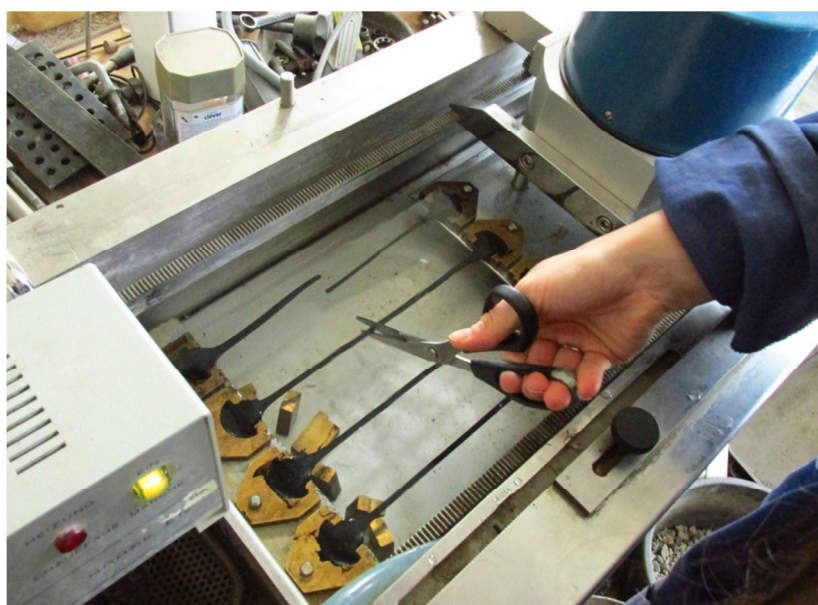
Obrázek 7: Přestřížení asfaltového vlákna
