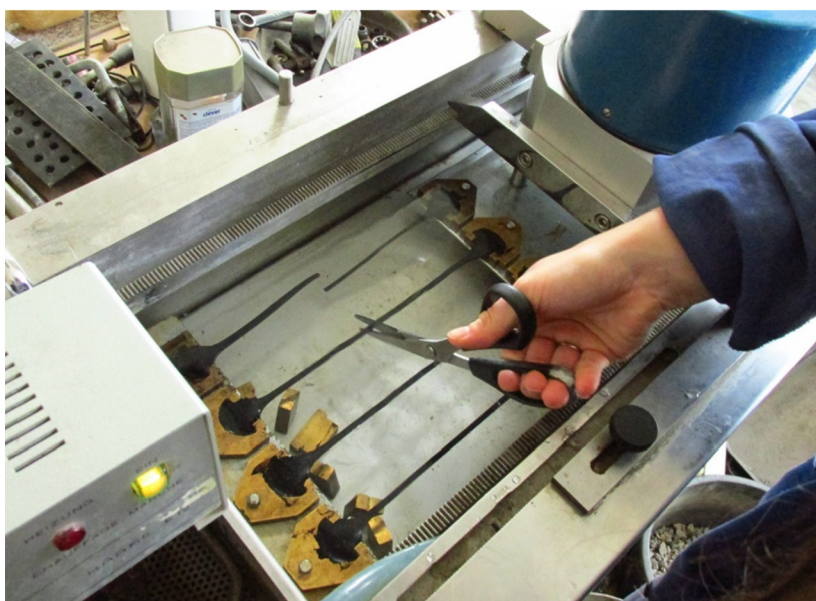
Obrázek 7: Přestřížení asfaltového vlákna
