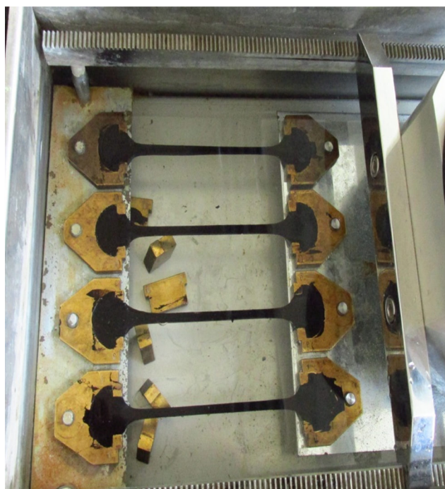
Obrázek 6: Průběh zkoušky vratné duktility
