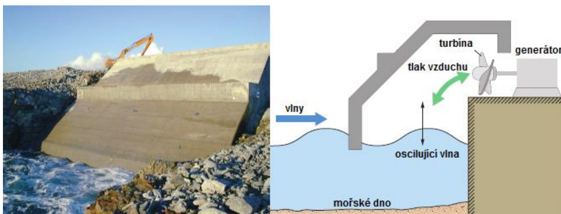
Obr. 4.3: Elektrárna typu LIMPET (převzato z [2])
