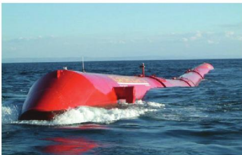
Obr. 4.4: Pelamis Wave Power Converter (převzato z [2])
