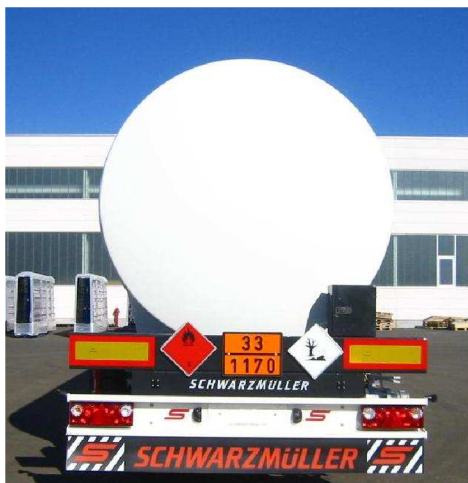
Obr. 3 Označení cisterny převážející etanol [11]
