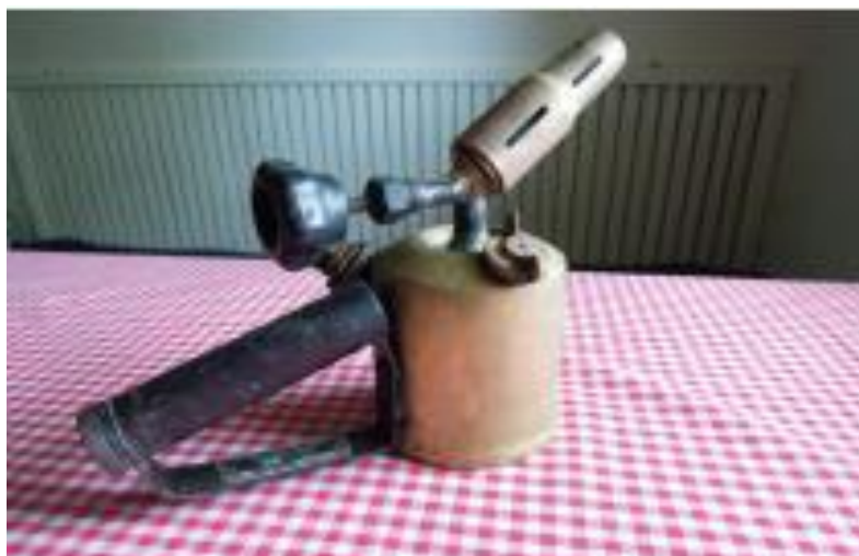
Obr. 11: Benzínová páječka – demontovaný hrot pájení
