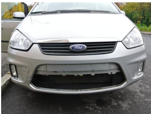
Obrázek 14 - poškozená přední část vozidla v důsledku střetu se zvěří
