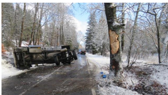
Obrázek 17 - pohled na stopy vzniklé při nárazu vozidla do stromu,
