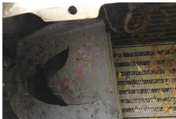
Obrázek 15 - detailní pohled na stopy po zvěří (srst a biologický materiál)
