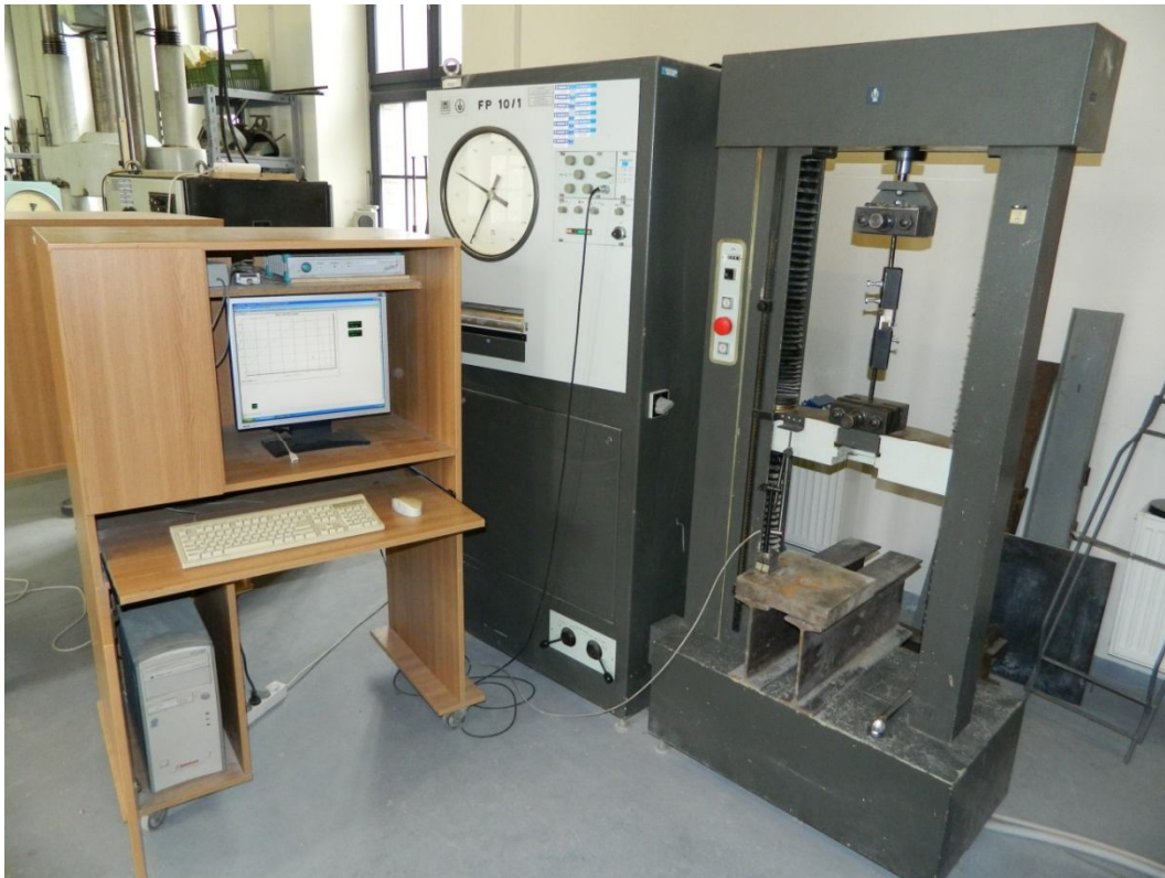
Obr. 26 Trhací zařízení FP 10/1
