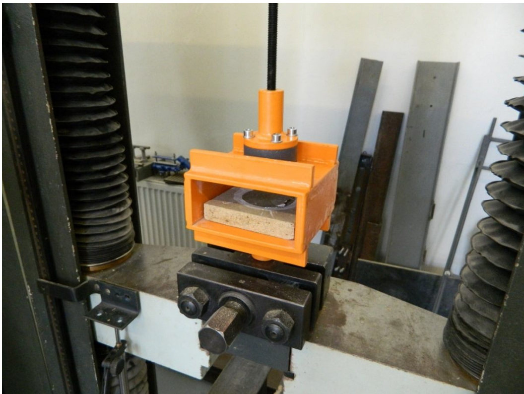
Obr. 27 Zkoušení přídržnosti/pevnosti v tahu
