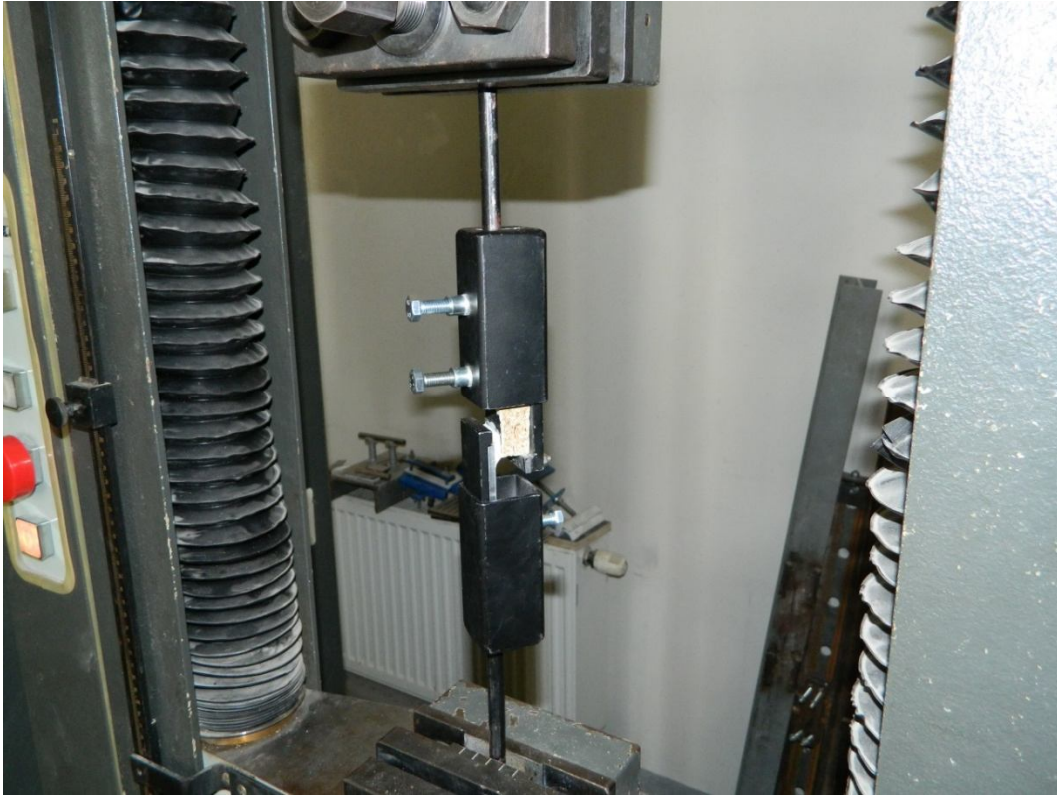
Obr. 28 Zkoušení pevnosti ve smyku
