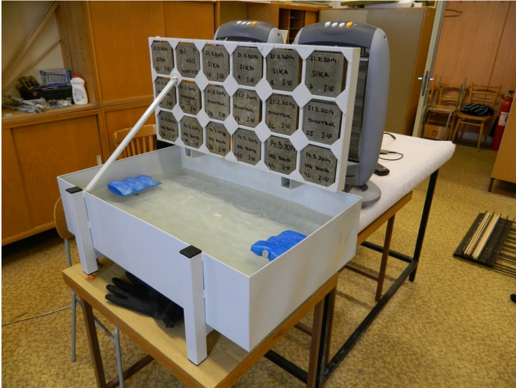
Obr. 25 Kondicionování vzorků na náhlé teplotní změny
