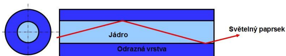
Obrázek 15: Princip vedení světla ve vlákně. (Zdroj: ONDRÁK, V. Počítačové sítě – Reálná přenosová prostředí . Přednáška, s. 19)
