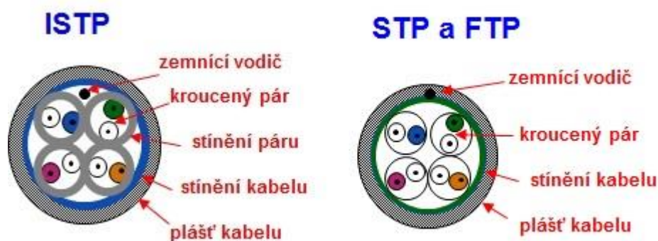
Obrázek 12: ISTP, STP a FTP – nestíněný párový kabel. (Zdroj: ONDRÁK, V. Počítačové sítě – Reálná přenosová prostředí . Přednáška, s. 9)
