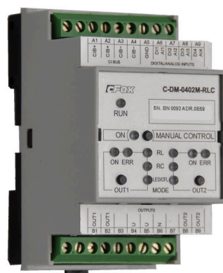
Obr. 7.7: Modul dvoukanalového stmívače s fázovým řízením [29]
