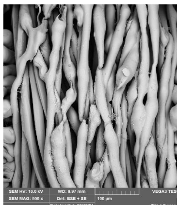
Obrázek 27: Ozařování při intenzitě 65 [μs]
