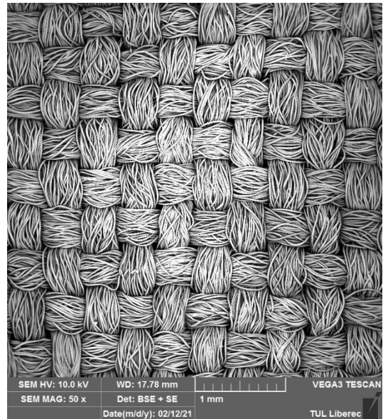
Obrázek 6: Elektronová mikroskopie tkaniny - 1 [mm]
