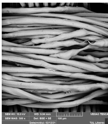
Obrázek 26: Ozařování při intenzitě 45 [μs]
