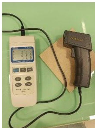
Obrázek 18: Přístroj na měření souřadnic RGB
