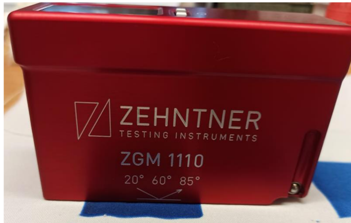
Obrázek 17: Přístroj na měření lesku
