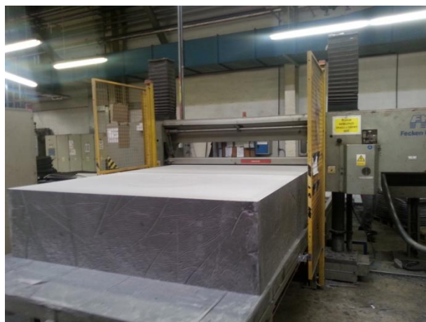
Obrázek 20 – Vodorovné řezání PUR pěny
