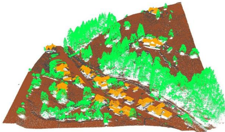
Obrázek 3.5 Klasifikovaný LiDAR, Pec pod Sněžkou (zobrazeno pomocí LASTools - lasview)
