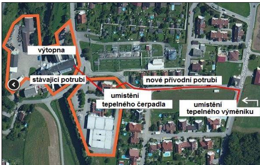
Obrázek 23: Dispoziční řešení využití tepla odpadních vod v rakouském Amstettenu (Bellò, 2012).
