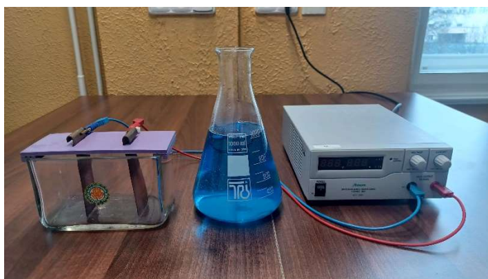
Obrázek 40: Vzhled aparatury pro elektrolýzu.
