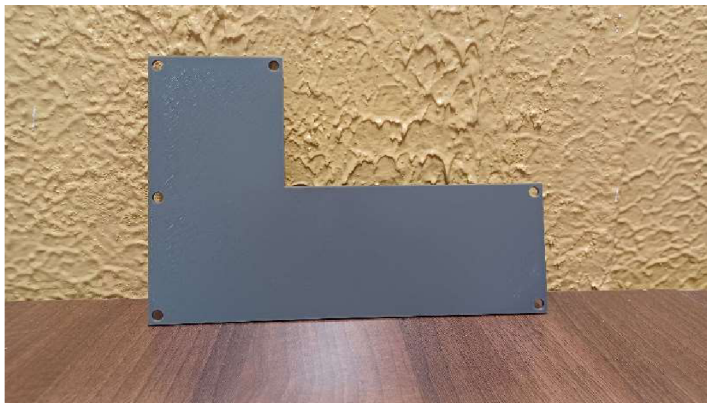
Obrázek 21: Výtisk tělesa, u kterého proběhne hledání těžiště.
