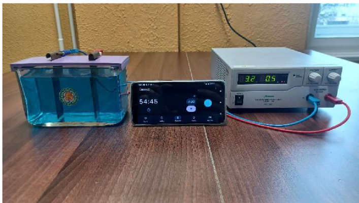
Obrázek 41: Vzhled aparatury po započeti elektrolyzy.
