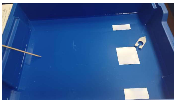
Obrázek 13: Stav lodičky po nanesení detergentu do výřezu.
