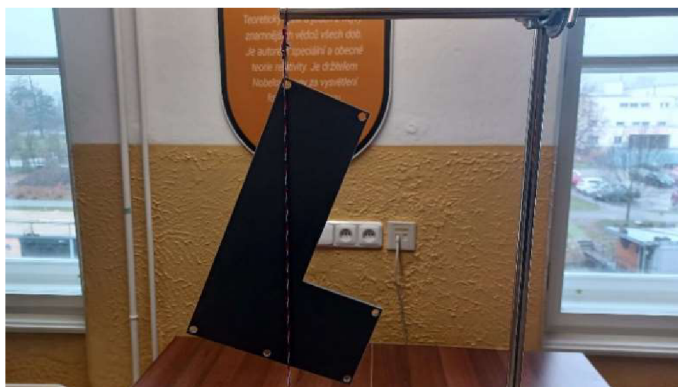
Obrázek 22: Orientace modelu pro konstrukci první těžnice.
