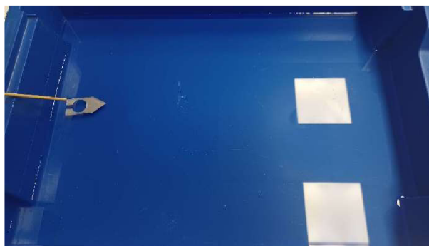
Obrázek 11: Lodička před nanesením detergentu do výřezu.
