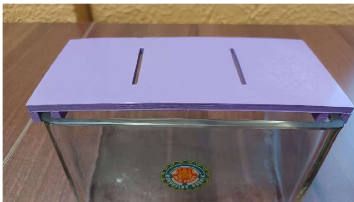
Obrázek 39: Výtisk držáku elektrod.
