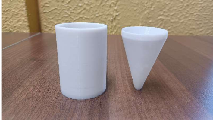
Obrázek 32: Výtisk kužele a válce.
